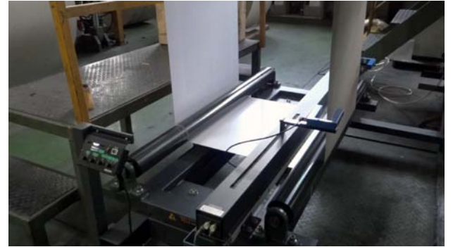
Çerçeve Hareketli Sistemi C-1500-BF kağıt kesme makinesi üzerinde kullanılmaktadır.
